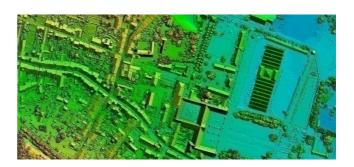
Uma vez realizada a aerotriangulação, um MDS pode ser gerado com a resolução especificada pelo usuário. Neste processamento, as regiões com sobreposição entre fotos contíguas são utilizadas como dados em estereoscopia para extrair a informação de elevação. Se for necessário, uma nuvem de pontos pode ser gerada em paralelo no mesmo processo.
