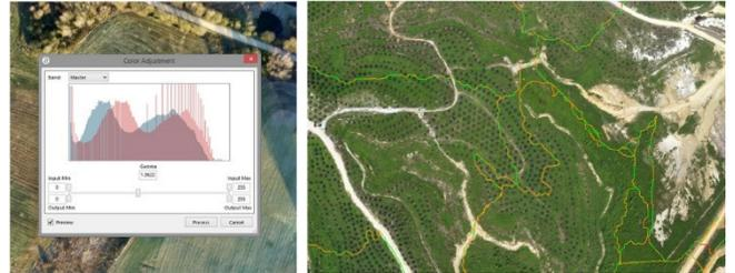
Los mosaicos generados automáticamente se pueden ajustar interactivamente. El módulo para editar el mosaico permite alterar las líneas de unión, permitiendo visualizar en tiempo real el efecto de los cambios efectuados sobre el producto final. También se puede usar para ajustar la tonalidad general de los colores en el mosaico y realzar su apariencia. Cuando se completa la edición, se puede exportar el mosaico siguiendo un sistema de recortes definido por el usuario.
