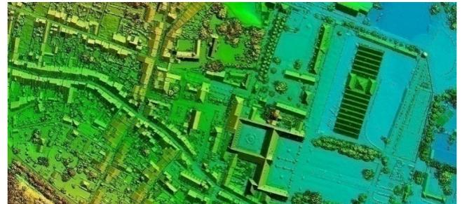
Una vez realizada la aerotriangulación, se puede generar un MDS con la resolución que especifique el usuario. En este procesamiento, las regiones con superposición entre fotos contiguas se utilizan como datos en estereoscopia para extraer la información de elevación. Si fuera necesario, se puede generar una nube de puntos paralelamente en el mismo proceso.
