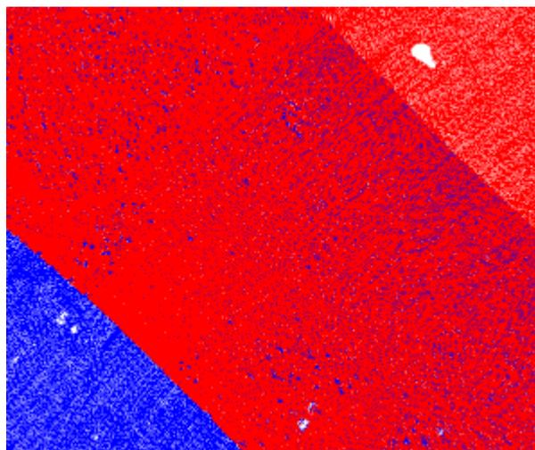
**Colorização por ângulo de escaneamento** – Neste modo, a nuvem de pontos é colorizada conforme o atributo que descreve o seu ângulo de escanização, com valores variando de -90 até +90 graus. As cores usadas podem ser moduladas usando as opções de sombreamento escolhidas para o espaço de trabalho.
