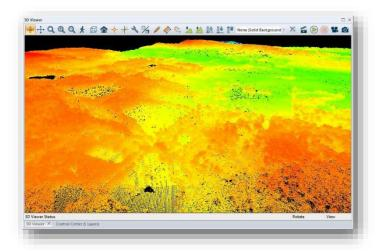
Os dados LiDAR são importados usando o procedimento padrão de abertura de arquivo, (Ctrl+O), porém a caixa de diálogo subsequente é própria a este formato. Nesta janela, os dados podem ser filtrados, reamostrados, e se necessário, podem ser diretamente convertidos em grade de altimetria numa camada de elevação.
